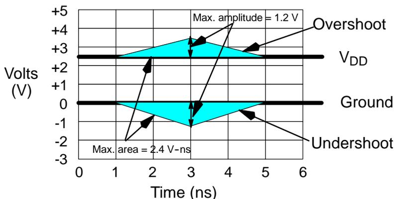
**Figure 36: DQ/DM/DQS AC Overshoot and Undershoot Definition**
