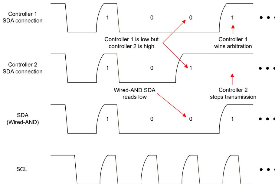
**Figure 6-6. I<sup>2</sup>C Controller Arbitration**
