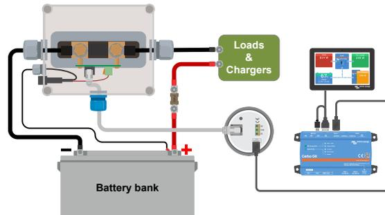
*Il monitor della batteria è collegato a un [Cerbo GX](#) e a uno schermo [GX Touch](#).*
